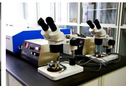
显微熔点测定仪
