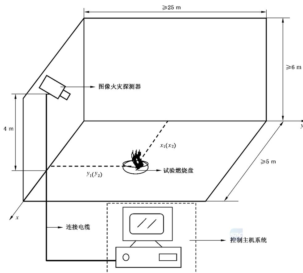
图 4 试验设备和场所示意图
