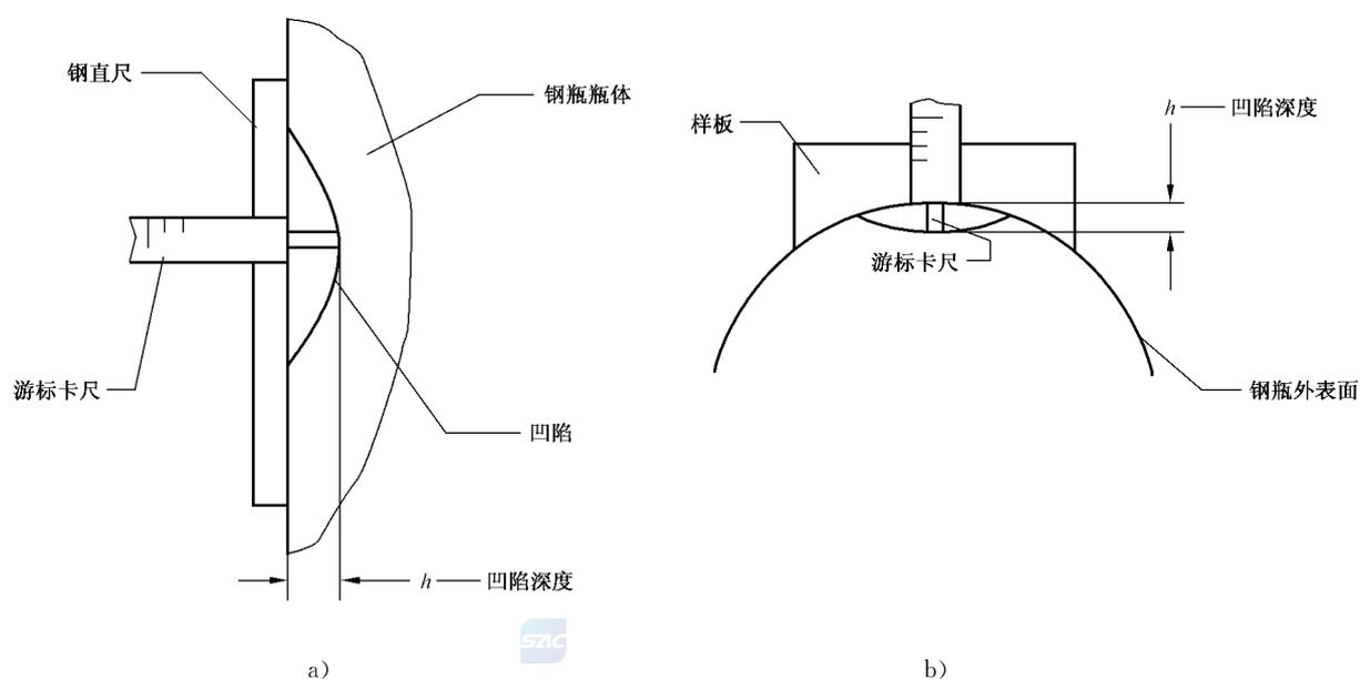
图 A.1 凹陷深度测量示意图
